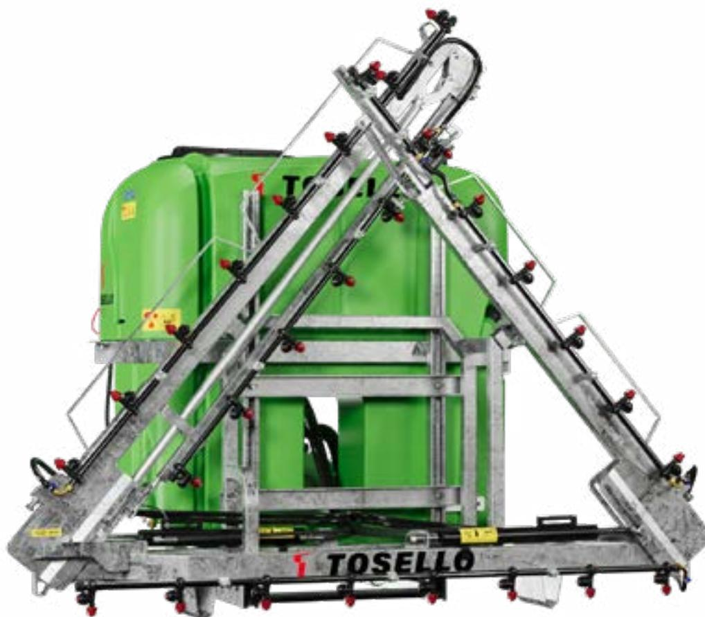
**Polverizzatore portato pensato per le esigenze dei produttori di vegetali in serra. Si distingue per la barra da diserbo asimmetrica che permette di applicare i fitofarmaci rispettando il layout a baulature tipico delle serre. Disponibile in una unica misura da 7,5 m di copertura e getti a distanza di 25 cm oppure 50 cm.**
