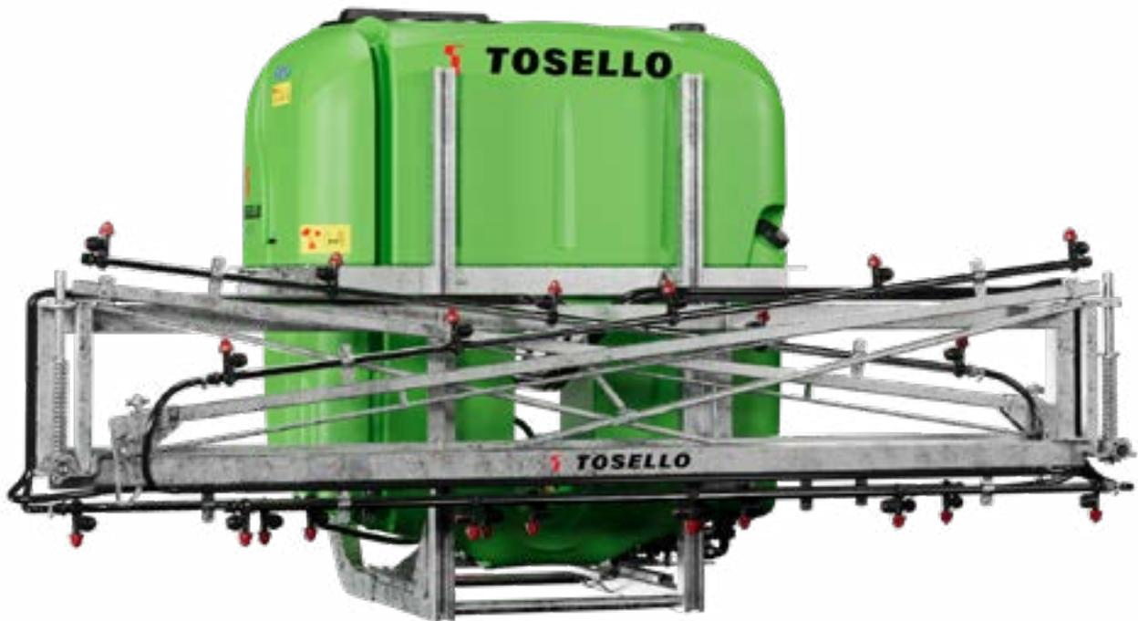
**Polverizzatore portato estremamente versatile e leggero, adatto a lavorazioni su appezzamenti di piccole e medie dimensioni. Viene fornito con barra meccanica da 3,5 a 16 metri di ampiezza di lavoro a seconda delle versioni. A richiesta si possono applicare le barre della serie ZC-Pro, vedi pag 19.**
