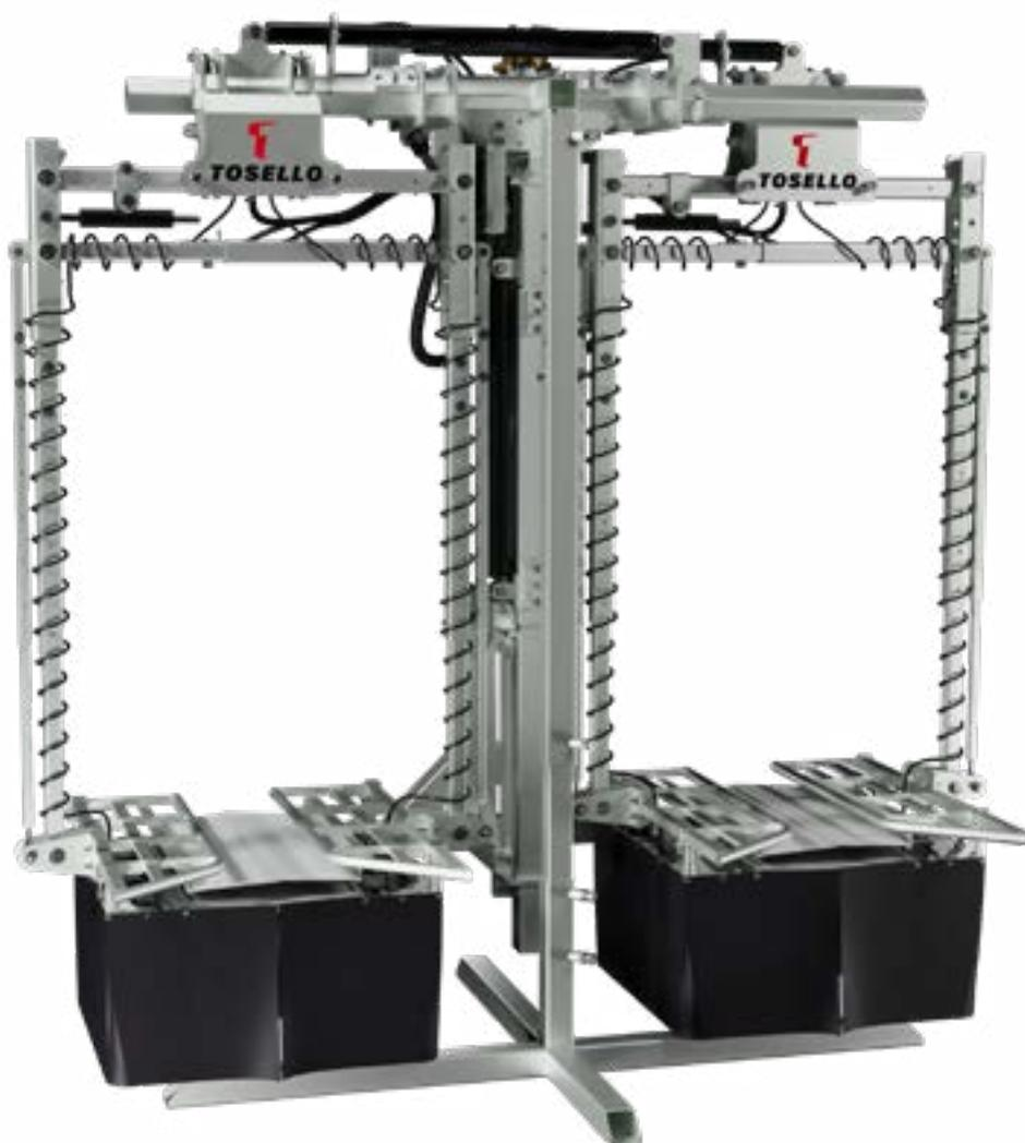
Attrezzatura da installare davanti alla trattoria, è dotata di una struttura scavallante in modo da poter lavorare due file per volta. Dotata di sei cilindri oleodinamici che permettono le regolazioni in sollevamento, spostamento laterale, apertura teste, inclinazione. Sono presenti inoltre degli ammortizzatori per facilitare la marcia su terreni dissestati. La macchina viene fornita con teste spollonanti di serie, sono invece opzionali i supporti per i coni in gomma per il diserbo sottofila.
