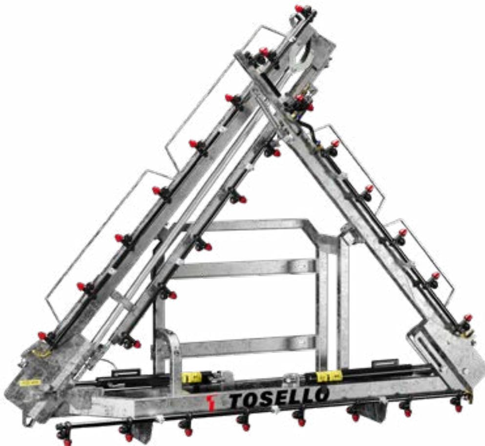
Barra da diserbo applicabile a gruppi diserbanti già esistenti oppure abbinabile ai nostri polverizzatori portati. Si distingue per il fatto di essere di dimensioni perfette per le serre, avendo una ampiezza di 7,5 m in modalità asimmetrica, e per la zincatura a caldo che preserva il telaio da corrosioni dovute ai prodotti chimici. Può essere equipaggiata con portagetti a 50 cm oppure a 25 cm. L'apertura e la chiusura sono idrauliche per un confort di lavoro ineguagliabile.
