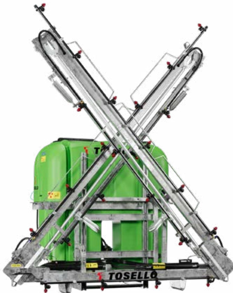
**Polverizzatore portato professionale per aziende agricole medio - grandi. È il giusto compromesso tra economicità e prodotto di qualità. Questo tipo di macchina ha una capacità del serbatoio che va da 400 a 600 litri, dotato di barra diserbo idraulica modello L2 da 6 a 12 metri di ampiezza.**
